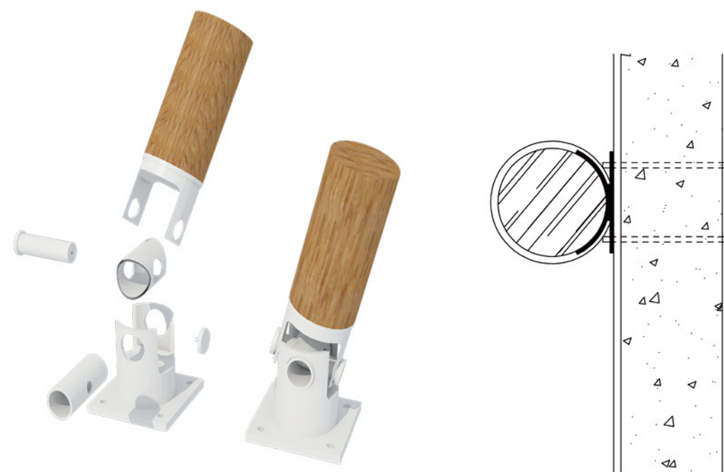
柱子连接细部 Bamboo column connection
